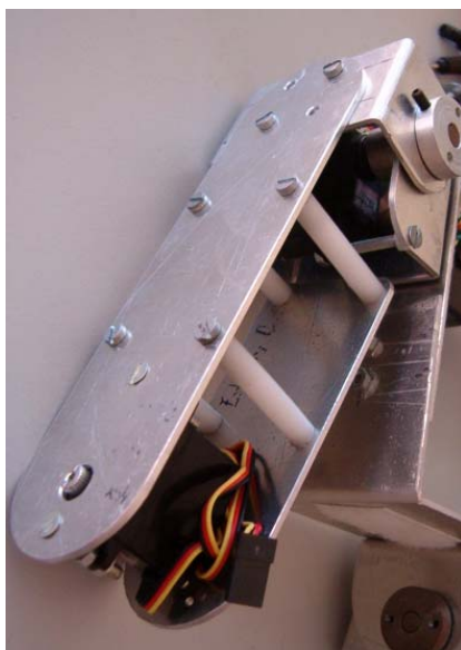
Fig. 85 – Montagem dos braços, ligados ao tronco.
