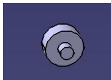
Fig. 21 – Adaptador para o motor da anca à frente.
