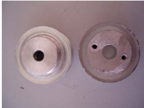
Fig. 104 – Polias comprada e polia depois de maquinada.
