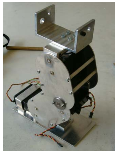
Fig. 28 – Montagem da perna.
