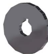
Fig. 10 – Roseta com encaixe para chaveta.
