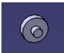
Fig. 20 – Adaptador para os motores do tornozelo e joelho.
