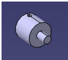
Fig. 19 – Adaptador para o motor do pé.
