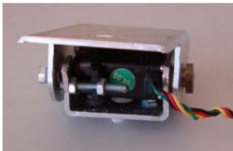
Fig. 87 – Montagem do pescoço e cabeça.
