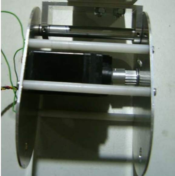
Fig. 70 – Montagem da estrutura da coxa.
